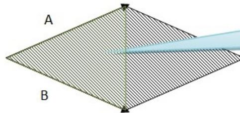
$\frac{|A \times B|}{2}$  = Área del triángulo de lados A y B
